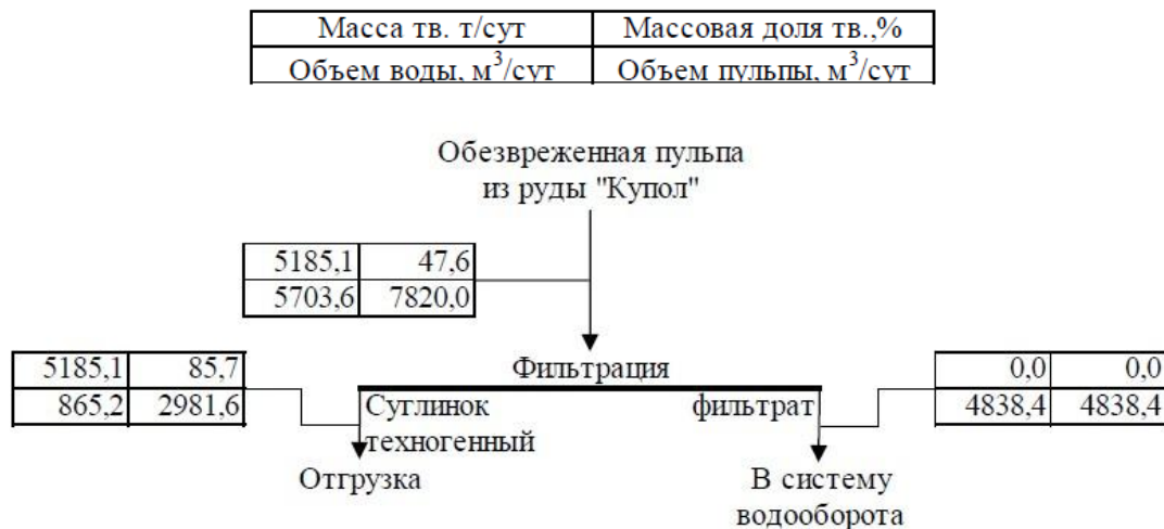
Рисунок 4.1. Водно-шламовая схема узла фильтрации пульпы хвостов ЗИФ месторождения «Купол»
